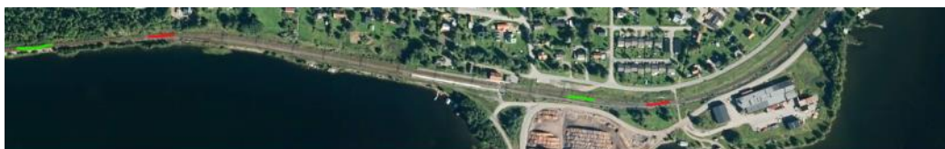
Figur 46: Gällö driftplats. Rött markerar nuvarande växellägen. Grönt markerar nya föreslagna lägen.
