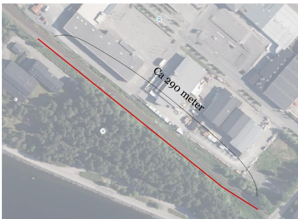
Figur 50: Förlängning av dubbelspår, Östersund södra utfart.
