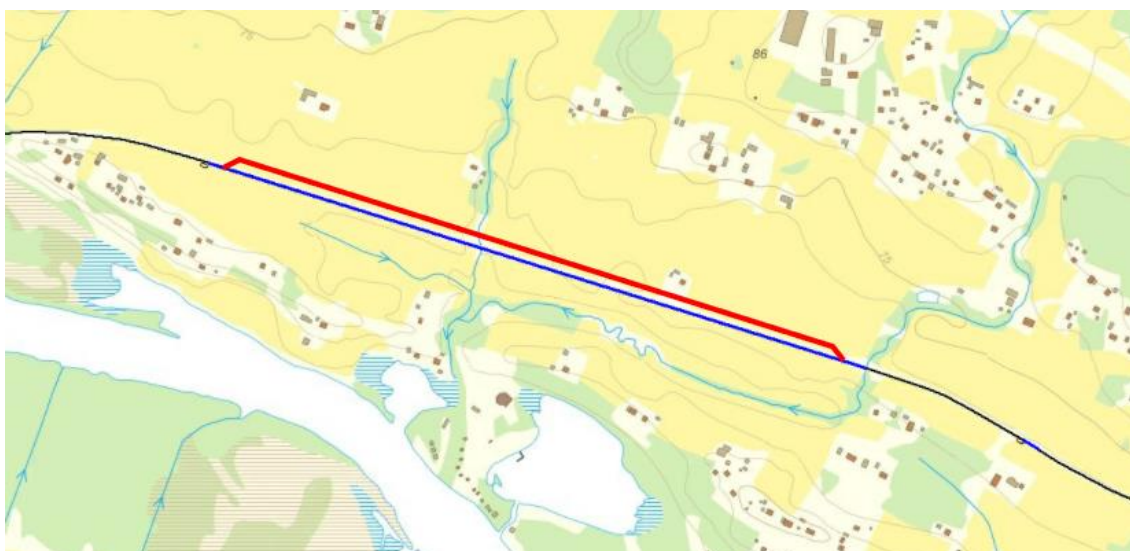
Figur 24: Alt. 3 mötesspår mellan Fränsta och Torpshammar. Raklinje i blått och mötesspår i rött.
