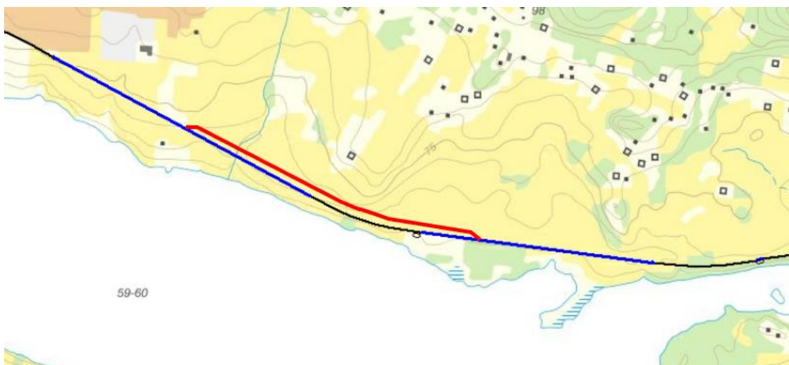
Figur 19: Mötesspår Alt. 1 mellan Fränsta och Torpshammar. Raklinje i blått och mötesspår i rött.
