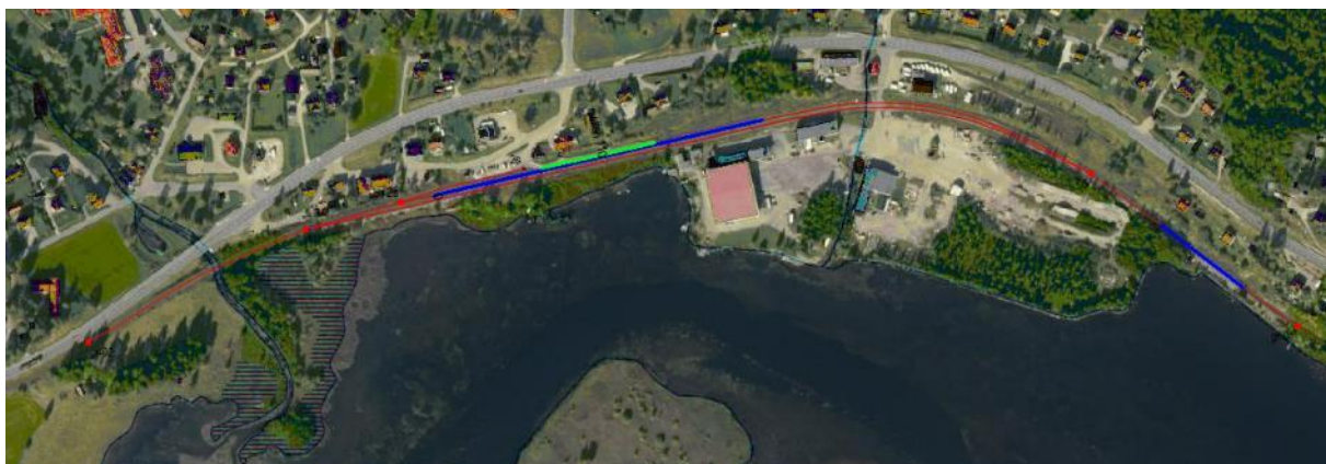
Figur 10 Stöde driftplats. Raklinjer markerade i blått och plattform vid spår 2 i grönt. Alternativet är avfärdat.
