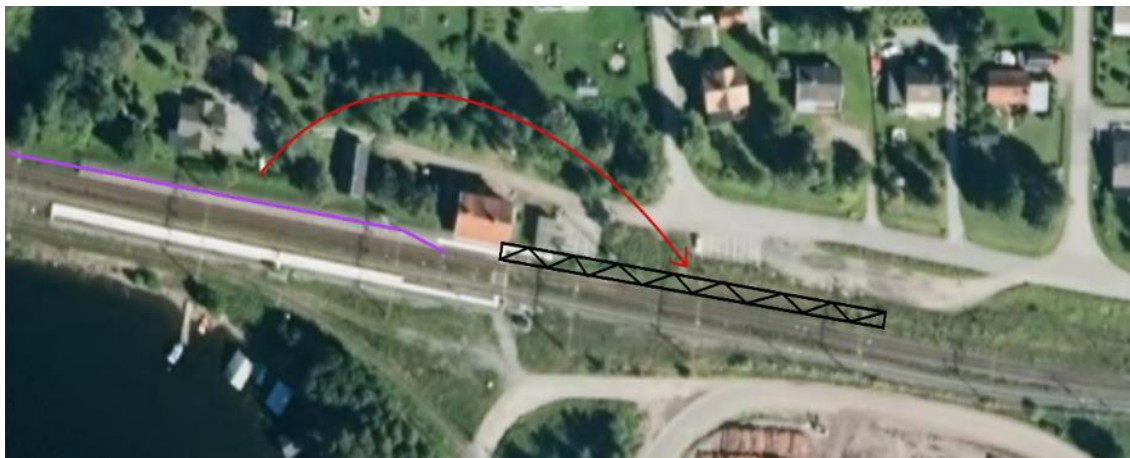
Figur 42: Gällö driftplats. Flytt av plattform.
