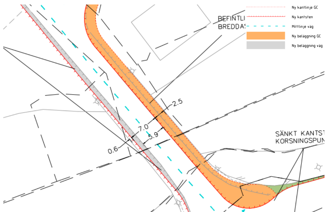
Figur 4-4 Avsmalning utmed befintlig bro där västlig gångbanan utgår för att medge breddning av östlig.
