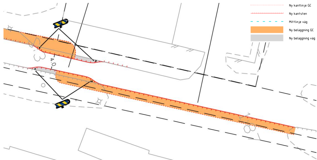
Figur 4-8 Föreslagen avsmalning vid gångbanans sidbyte utmed Näldevägen
